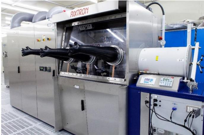
Die MOCVD-Anlage des Fraunhofer IAF wurde von der Forschergruppe so umgebaut, dass AlScN in einer für die Industrie geeigneten Qualität und Produktivität realisiert werden kann.
