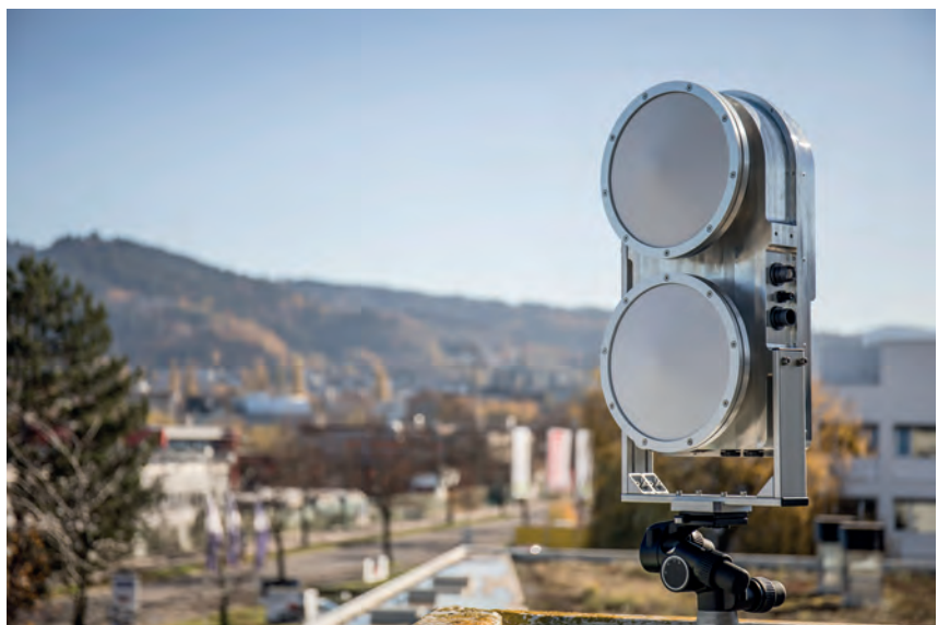
Abb. 2: Erste autonom arbeitende 300-GHz-Funkeinheit mit integrierter elektrooptischer Glasfaserschnittstelle, die Drahtlos-Übertragungen bis 100 Gbit/s ermöglicht
